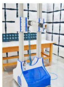
■ 高频俯仰天线塔
