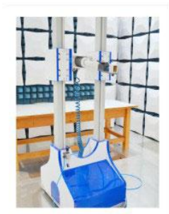
■ 高频俯仰天线塔
